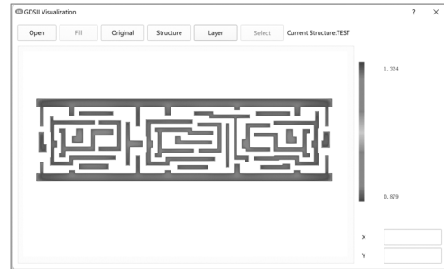
(b) 经过邻近效应剂量校正的曝光剂量版图
